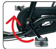
O2 - Freno con los pedales
