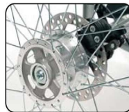
B1 - Freno de disco ruedas traseras
