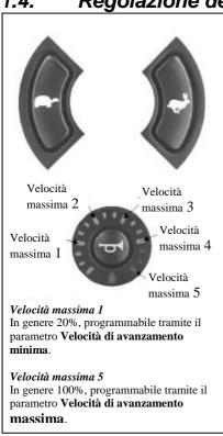
La velocità massima della carrozzina può essere regolata in base alle esigenze e all'ambiente in cui ci si trova. La velocità massima corrente viene visualizzata sull'indicatore di velocità e può essere regolata tramite gli appositi pulsanti per l'aumento (lepre) e la diminuzione della velocità (tartaruga).
