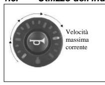
L'indicatore di velocità viene utilizzato per misurare la velocità relativa della carrozzina rispetto alla velocità massima possibile. La luce LED più a destra indica la velocità massima corrente che può essere regolata tramite i pulsanti appositi per la regolazione della velocità. Utilizzando il joystick, aumentando la velocità della carrozzina, le luci LED si illumineranno fino al raggiungimento della velocità massima, come illustrato nell'immagine.
