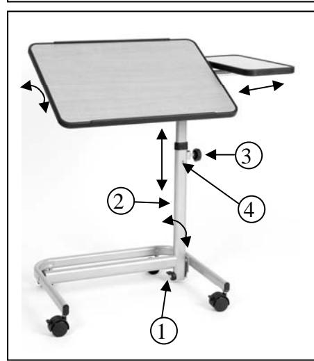
Poussez le levier ① vers le bas et glissez le tube ② du cadre inférieur vers le haut (75° ou 90°). Vérifiez que le tube est fixé fermement. Assemblez la tablette grande dans le cadre inférieur et fixez à l'aide de la molette de serrage ③ à la hauteur souhaitée (**La hauteur maximale est jusqu'à ce que la cheville de blocage ④ s'en cliquète dans l'orifice**). Montez la tablette, petite avec la rondelle et la vis.
