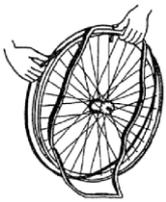
Faites glisser la garniture de jante au-dessus de la valve de la chambre à air et introduisez ensuite celle-ci dans la jante. Vous pouvez maintenant tendre la garniture de jante sans difficulté. Vérifiez que toutes les têtes de rayon sont recouvertes (aucune garniture de jante n'est utilisée avec les jantes en matière plastique).
