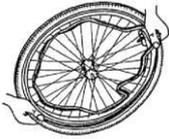
Prenez maintenant le pneu et enfoncez-le derrière la valve en commençant au-dessus du rebord de jante. Ensuite, gonflez légèrement la chambre à air jusqu'à ce qu'elle prenne sa forme ronde et se place dans le pneu.
