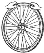
Si la chambre à air se place dans le pneu sans le moindre pli sur toute la périphérie (si des plis se forment, laissez s'échapper un peu d'air), vous pouvez poser la face supérieure du pneu, en commençant du côté opposé à la valve, en appuyant légèrement avec les deux mains en allant vers la valve.
