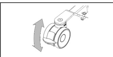
2. Avant l'installation, empêchez tout déplacement involontaire du lève-personne en actionnant les roues avec freins. Appuyez légèrement de la pointe du pied sur la patte du frein des roues en l'abaissant jusqu'à ce qu'elles soient bloquées. Pour desserrer les freins, soulevez de la pointe du pied la patte du frein vers le haut jusqu'à ce que les roues soient libérées.
