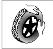
Lorsque le pneu intérieur se trouve tout autour sans plis dans le pneu extérieur (s'il y a des plis : laissez un peu d'air), vous montez alors la partie supérieure du pneu en commençant par la valve prudemment en appuyant des deux mains sur la valve.
