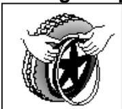
Placez le pneu intérieur sans air autour de la jante. Veillez à ce que la valve dépasse de l'ouverture de ventilation de la jante.
