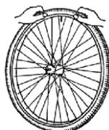
Se la camera d'aria aderisce completamente intorno al copertone senza pieghe (se si piega lasciare uscire un po' d'aria), è facile inserire la parte superiore del pneumatico con entrambe le mani sopra alla valvola a partire dal punto in corrispondenza alla valvola.
