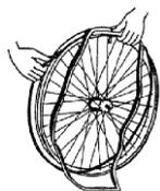
Spingere la protezione della camera d'aria sopra la valvola di quest'ultima ed inserirla nel cerchione. A questo punto la protezione della camera d'aria può essere facilmente montata. Verificare che tutte le teste dei raggi siano coperte (se si utilizzano cerchi in plastica non si utilizza la protezione della camera d'aria).
