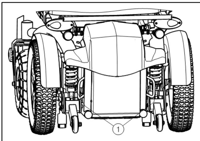
Pour votre confort, la puissance du ressort peut être réglée. Le ressort se trouve à l'arrière du fauteuil électrique, derrière le boîtier de la batterie.
