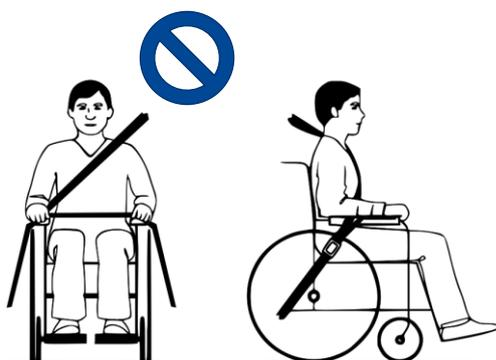
**Figure 3** Mauvaise position des retenues de la ceinture
