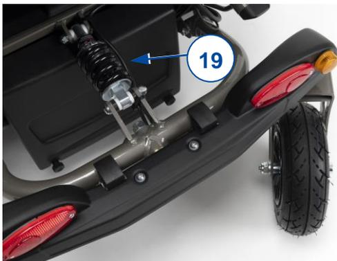
Pour votre confort, la puissance des ressorts peut être réglée. Les ressorts se trouvent à l'arrière du fauteuil électrique, derrière le boîtier de la batterie.
