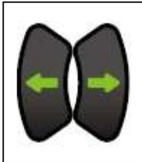
Para indicar un giro a izquierda o derecha, pulse el botón del intermitente izquierdo o derecho, según corresponda. El LED verde del intermitente que haya activado parpadeará. Pulse de nuevo el botón para apagar el indicador.
