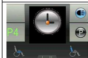
Mueva el joystick hacia la **izquierda/derecha** o pulse el botón de selección del menú (10) hasta que aparezca en el centro de la pantalla la función de ajuste de hora deseada.
