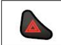
Para encender las luces de emergencia, pulse el botón Alarma intermitente. Los dos LED verdes de los intermitentes izquierdo y derecho parpadearán simultáneamente. Pulse de nuevo el botón Alarma intermitente para detener la luz de emergencia.
