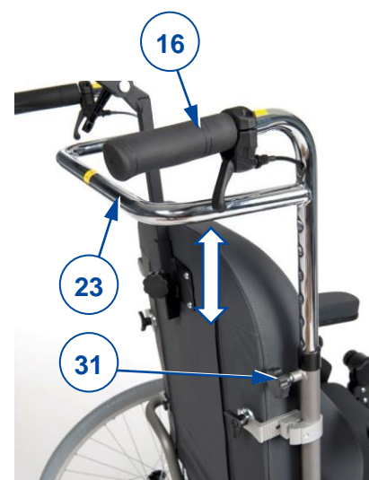
Figure 9 Réglage de la hauteur de la poignée de poussée
