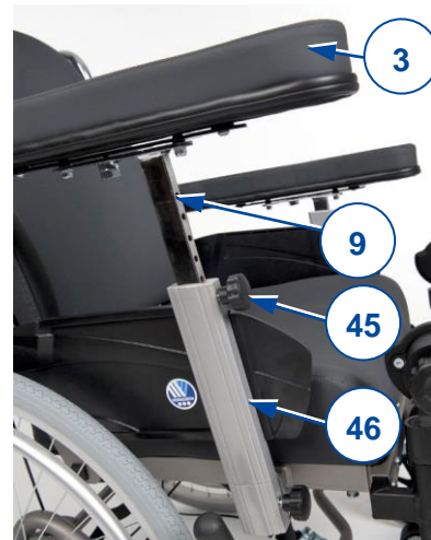
Figure 8 Réglage de la hauteur de l'accoudoir
