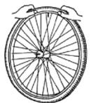
Se la camera d'aria aderisce completamente intorno al copertone senza pieghe (se si piega lasciare uscire un po' d'aria), è facile inserire la parte superiore del pneumatico con entrambe le mani sopra alla valvola a partire dal punto in corrispondenza alla valvola.
