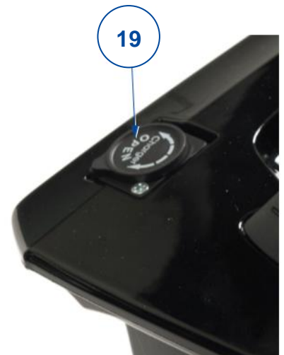
Figura 6 Punto de conexión para el cargador de batería
