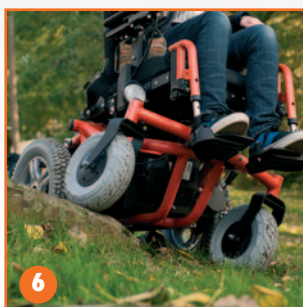
Eje de estabilidad: Sus 4 ruedas siempre están en contacto con el suelo
