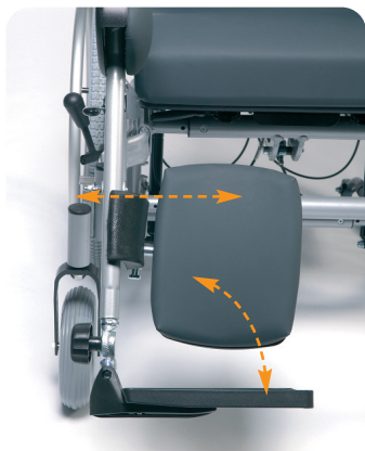
Beinstützen mit Längenausgleich nach außen + innen abklappbar, höhenverstellbar, Fuß- und Wadenplatten einstellbar, Spitzfußverstellung
