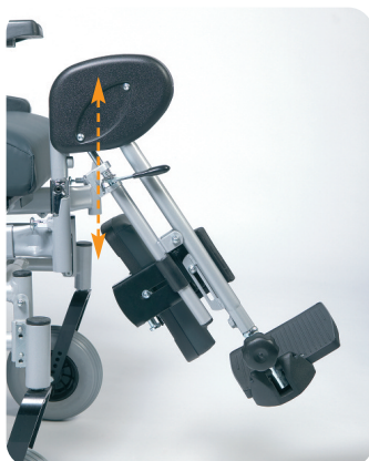
Beinstützen mit Längenausgleich nach außen + innen abklappbar, höhenverstellbar, Fuß- und Wadenplatten einstellbar, Spitzfußverstellung
